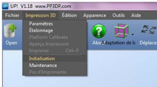
L'imprimante émet 4 bips et la procédure d'initialisation débute, les trois axes se mettent en mouvement pour prendre leurs origines. Elle émet à nouveau un bip lorsqu'elle est prête.
