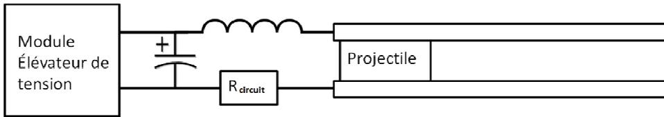
Pour une bobine d'inductance  $L$ , l'ensemble des imperfections est représentée par une résistance  $r$  et un facteur de qualité  $Q_L(\omega) = \frac{\omega_0 L}{r}$
