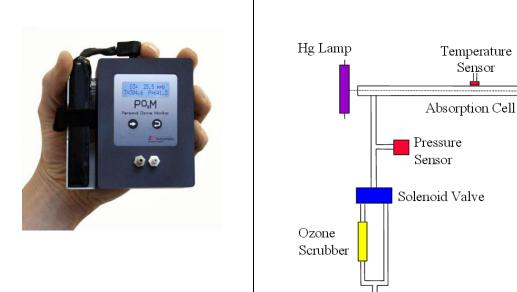
Ce schéma correspond à la version non portable, dans le POM la cellule d'absorption est coudée et transmet la lumière à l'aide d'un jeu de miroir.
