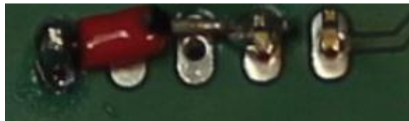
Figure 9 Rattrapage branchement connecteur batterie
