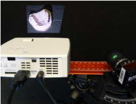
Configuration de l'objet et arrangement du projecteur et de la caméra
